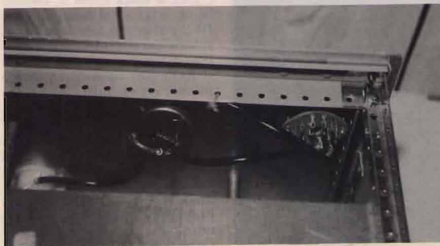
10 Particolare della sonda per la misurazione delle onde stazionarie.
